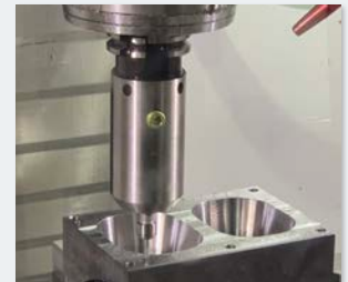
Abbildung 5: A 625X HSK-A63 mit TSA (Thru-Toolholder Air Supply) Air Turbine Spindle®-Montage. Alle HSK-Spindeln können mit mittlerer Luftzufuhr verwendet werden, wenn die Luftzufuhrleitung einen ausreichenden Innendurchmesser hat.
