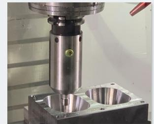
**Abbildung 17:** A 625X HSK-A63 mit TSA (Thru-Toolholder Air Supply) Air Turbine Spindle®-Montage. Alle HSK-Spindeln können mit mittlerer Luftzufuhr verwendet werden, wenn die Luftzufuhrleitung einen ausreichenden Innendurchmesser hat.
