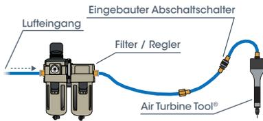
**Abbildung 1:** Reinigen Sie die Luftleitung von einem Filter/Regler bis zu einem Luftturbinen-Handwerkzeug.
