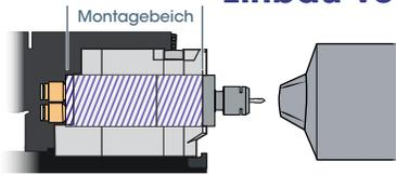
Es ist notwendig, dass Ihre Vorrichtung nicht über die Lager geklemmt wird. Eine falsche Positionierung oder ein zu starkes Anziehen der Klemme an Ihrem **Air Turbine Live Tools®**-Stahlrohr führt zu Druck auf die Lager und zu vorzeitigem Ausfall. Um diesen Fehler bei der Installation zu vermeiden, sehen Sie **Abbildung 12** an. Verwenden Sie **Abbildung 13**, um zu sehen, wo sich der Montagebereich für jedes Air Turbine Live Tool®-Modell befindet.
