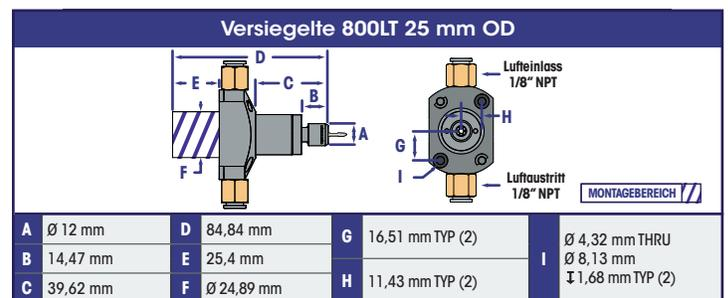
**Abbildung 13:** Tabellen, die den richtigen Montagebereich und die richtigen Abmessungen für die Montage von Air Turbine Live Tools® zeigen.
