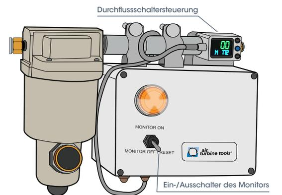
**Abbildung 23:** Diagramm des Strömungsschalters und des Systemmonitors.
