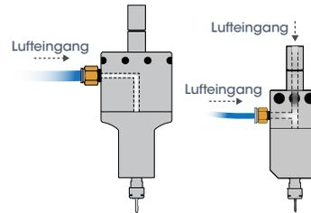
**Abbildung 16:** Ein 625JS mit seitlicher oder hinterer Lufteinlassmontage und eine 650JS mit seitlicher Lufteinlassmontage.
