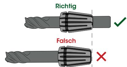
**Abbildung 7:** Ein Vergleich, der zeigt, wie das Schneidwerkzeug richtig und falsch in die Spannzange eingesetzt wird. **Stellen Sie sicher, dass das Schneidwerkzeug vollständig durch die Spannzange geht.** Die überstehende Länge des Schneidwerkzeugs aus Ihrer Spannzange sollte optimalerweise nicht mehr als 3 mal die Länge Ihres Schneidwerkzeugs.
