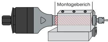
**Abbildung 14:** Ein montierter 202HD, der zeigt, dass das Gerät nur innerhalb des gekennzeichneten Montagebereichs befestigt ist.
