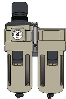
**Abbildung 22:** Stellen Sie sicher, dass der Filter/Regler richtig auf 90 psi/6,2 bar eingestellt ist.
