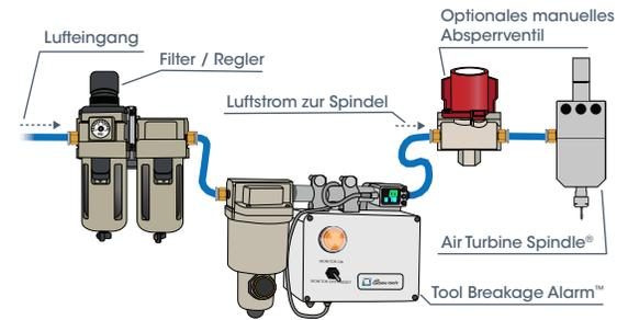
**Abbildung 21:** Systemmonitor-Luftleitungsdiagramm, das die Verbindung von einem Filter/Regler zum Tool Breakage Alarm™ und dann zu zeigt die Air Turbine Spindle®.
