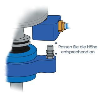
**Abbildung 20:** Einstellen der Höhe der Düsen schraube.
