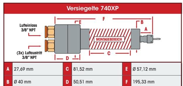
**Abbildung 15:** Tabellen, die den richtigen Montagebereich und die richtigen Abmessungen für die Montage von Air Turbine Motors® zeigen.
