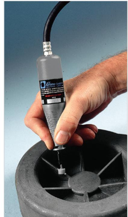
**표준 공급품:** 3mm 콜릿, 콜릿 체결용 렌치, 후방 배기. **SV:** 슬라이드 밸브가 장착된 1.5m 에어 공급 유닛과 1/4" 에어 공급 피팅. **DM:** 트리거 스위치와 1/4" 에어 공급 피팅. 다른 사이즈 옵션 콜릿과 액세서리 필터도 주문 가능.
