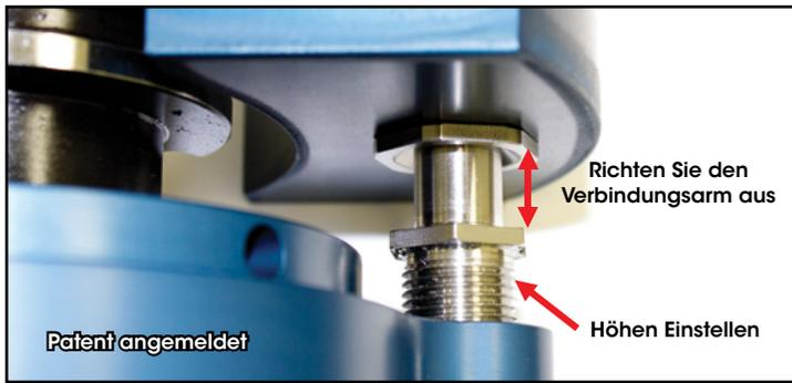
**4.** Schrauben Sie die Ventildüse in den Verbindungsarm bis sie die richtige Höhe hat um sich mit dem Montierblock so zu verbinden das es kein Luftleck gibt. Dann kontern Sie die Düse mit der Kontermutter, damit sie sich nicht mehr verstellen kann.
