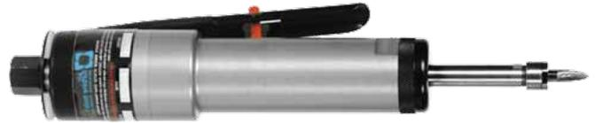
Цанга под инструмент -  $\varnothing$  6 мм
