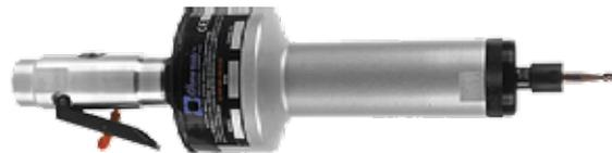
Цанга под инструмент -  $\varnothing 6$  мм
