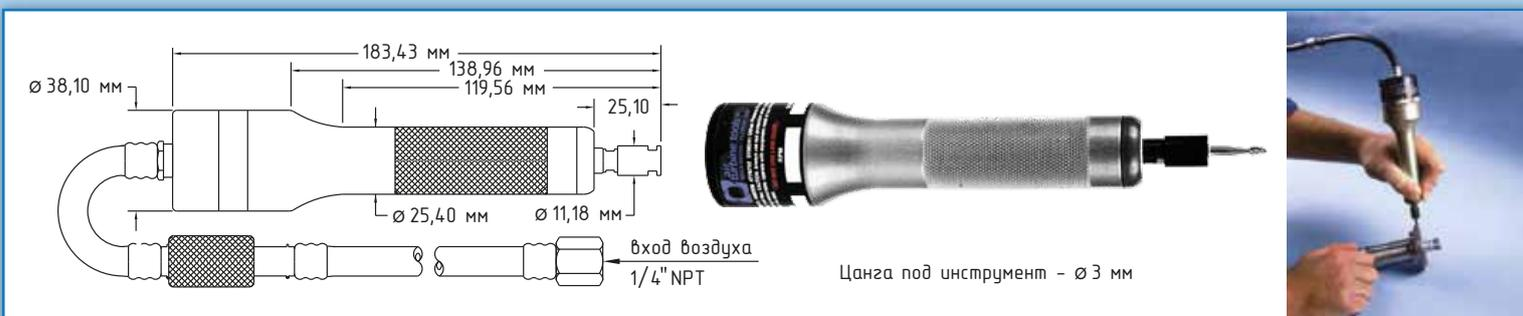
Цанга под инструмент -  $\varnothing$  3 мм
